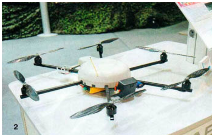
Рис. 1. БПЛА "Серафим" выполнен по схеме "шестикоптер" (ZALA AERO)
